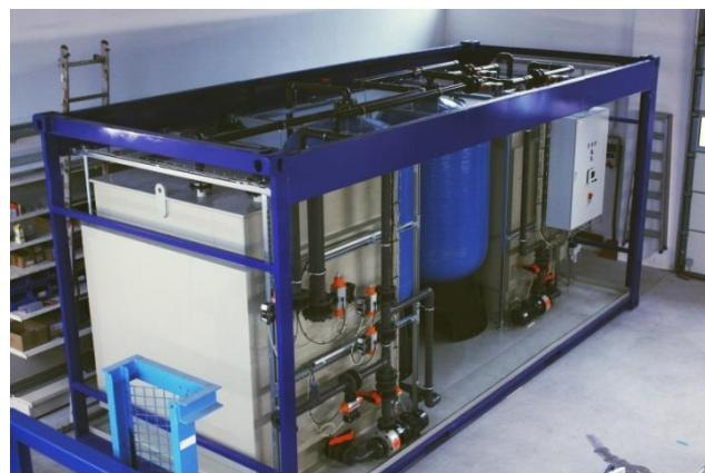
**High-Cube Container basierte Anlage mit 2000 Liter Harz zur Reinigung von 25% Schwefelsäure – sehr geringes Nachschärfen erforderlich – ca. 0,9 m<sup>3</sup>/h Durchsatz**
